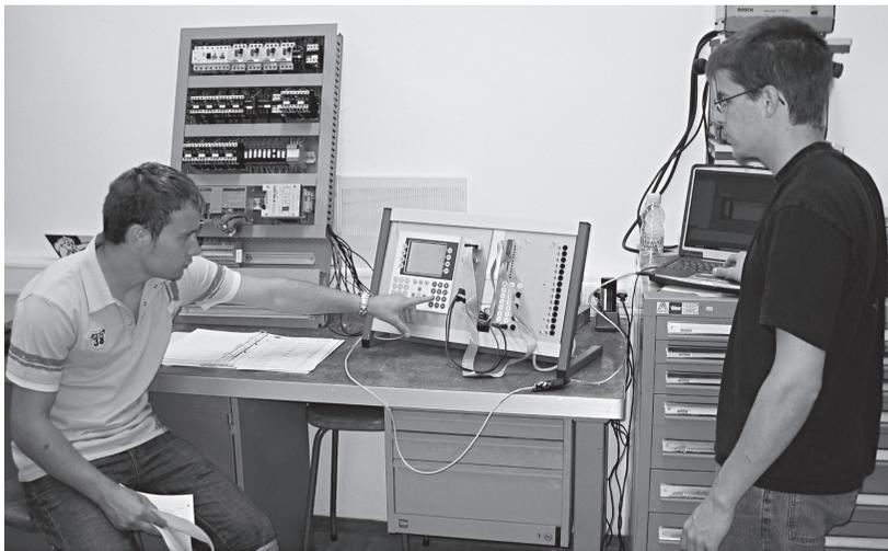
Erneuerung der Steuerung einer Fräsmaschine
