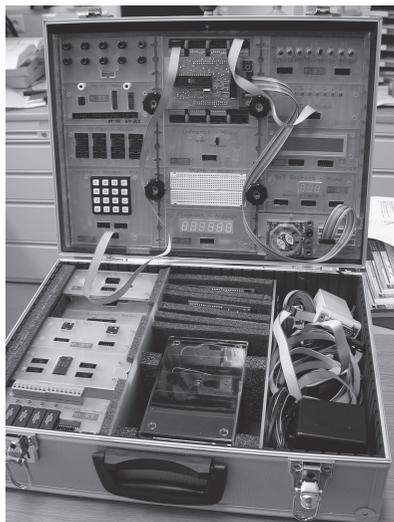
oder für Laborübungen auch separat neben dem Koffer betrieben werden. Der Koffer ist so aufgebaut, dass eine komplett verdrahtete Hardware-Schaltung im Koffer transportiert und betrieben werden kann, was vor allem für den Einsatz im Theorie-Unterricht oder für Präsentationen sinnvoll ist.
