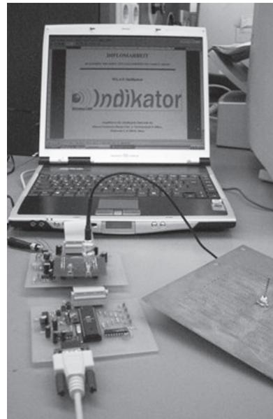
HF-Print, der mit einem WLAN-Chip bestückt ist. Dieser Chip mischt die 13 WLAN-Kanäle in das Basisband herunter. Gesteuert wird dieser über eine SPI-Schnittstelle (Serial-Parallel-Interface).
