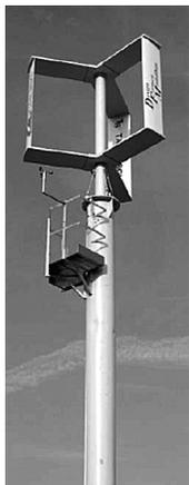
Aufgabe war, eine Windkraftanlage in Form eines Vertikalachsen-Windkonverters zu planen, zu konstruieren und zu bauen. Das Hauptaugenmerk lag dabei weniger auf der abgegebenen Leistung der Anlage, sondern vielmehr auf den durch diese Anlage gewonnenen Erkenntnissen
