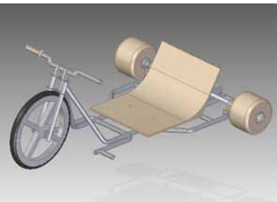
CAD-Konstruktion des elektrisch betriebenen Drift-Trikes
