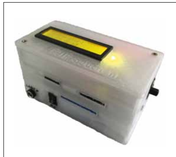
Der im Rahmen der Diplomarbeit von Josef Fuchs und Johannes Heiligenbrunner gebaute Datenschreiber registriert und speichert alle relevanten Bewegungen beim Modellbaufliegen, Radfahren und auch Skisport.
