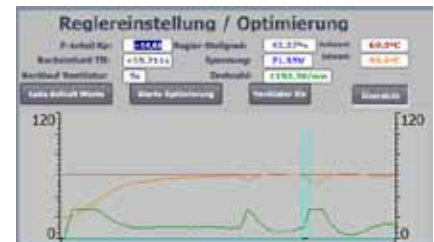
Sprungantworten dargestellt am Prozessleitsystem
