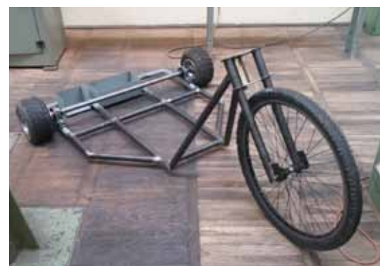
Rahmen-Konstruktion des Drift-Trikes mit montierten Rädern
