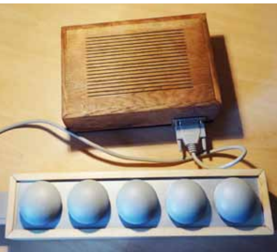
Der Reaktionstester von Marco Fellner und Markus Gastecker misst die Zeit, die für das richtige Tastendrücken benötigt wird und führt diese in Ergebnislisten zusammen.
