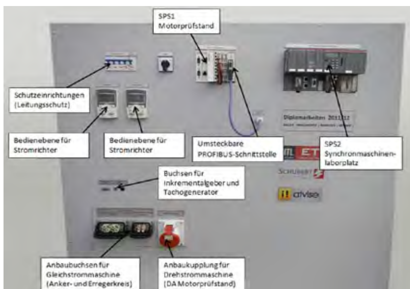
Bild 3: Frontansicht des Umrichter-Satzes
