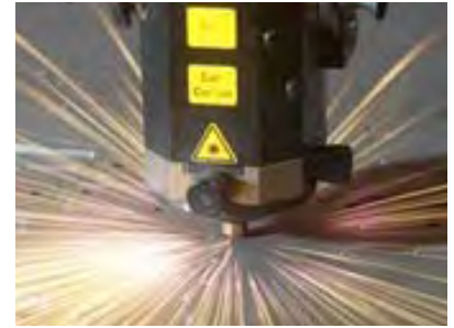
Stahlplatten werden mit einem Laser geschnitten
