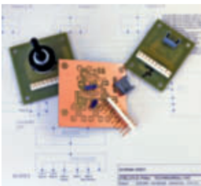
Selbstgefertigter dreiteiliger Print für den Videosplitter
